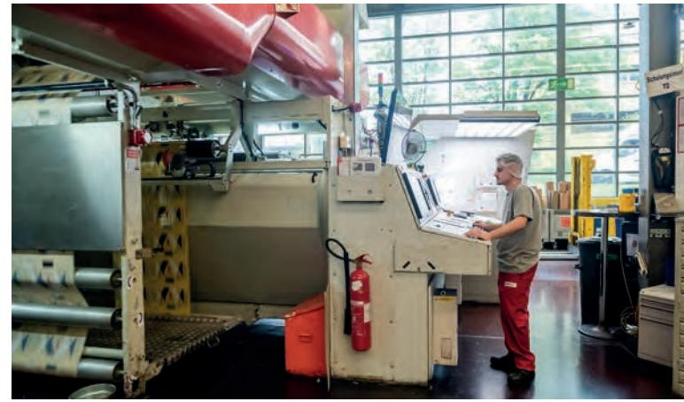
▲ Tiefdruckmaschinen benutzen Verpackungsdrucker bedienen riesige Tiefdruckmaschinen und kontrollieren, ob der Druckvorgang nach Plan läuft.
