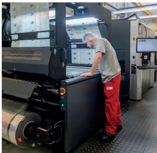
◀ Qualität kontrollieren Verpackungsdrucker überprüfen laufend die Qualität der Produktion und passen wo nötig die Einstellungen bei den Maschinen an.
