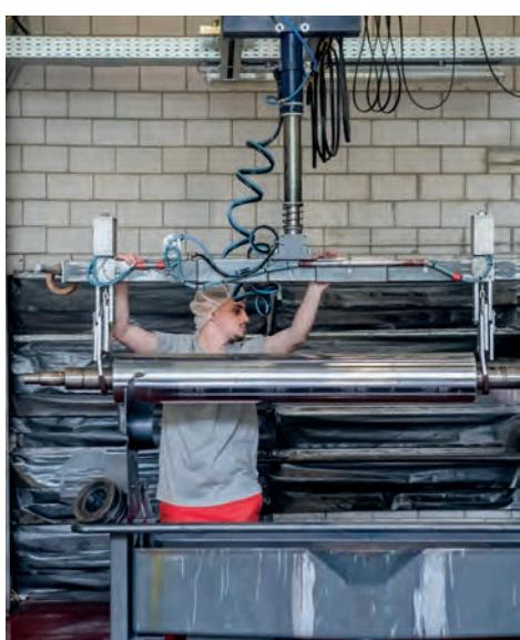
▲ Arbeitsplatz reinigen und Abfälle entsorgen Verpackungsdrucker putzen die Maschinen und Bestandteile, z.B. Zylinder, oder entsorgen gebrauchtes Material umweltgerecht.
