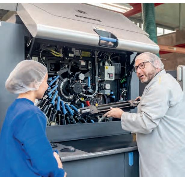
▼ Verena Da Costa richtet eine Flexodruckmaschine ein.
