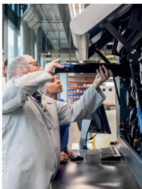
➤ Maschinen instand-halten Verpackungsdruckerinnen sorgen dafür, dass die Anlagen optimal funktionieren, und wechseln z.B. bei einer Digitaldruckmaschine die «Photo Imaging Plate» aus.
